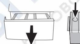
Чтобы вынуть из машины распределитель моющих средств, нажмите на сифоне в отделении для кондиционера на точку, указанную пунктиром, и потяните распределитель на себя.
