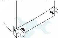
**!** Чтобы снять крышку фильтра, можно слегка прижать ее каким-либо инструментом с тонким пластиковым наконечником, вставив его в щель над крышкой. Не используйте для открывания крышки инструменты с металлическими наконечниками.
